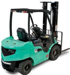
•DIESELKÄYTTÖINEN VASTAPAINOTRUKKI •2,0-3,5 TONNIA •4 PYÖRÄT
