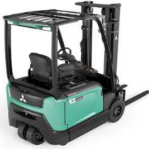
SÄHKÖKÄYTTÖINEN VASTAPAINOTRUKKI •1,4-2,0 TONNIA •3 PYÖRÄT •48 VOLTITIA •VAIHTOVIRTA
