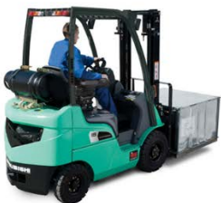
•LPG-KÄYTTÖISET HAARUKKATRUKIT •1,5-3,5 TONNIA •4 PYÖRÄT
