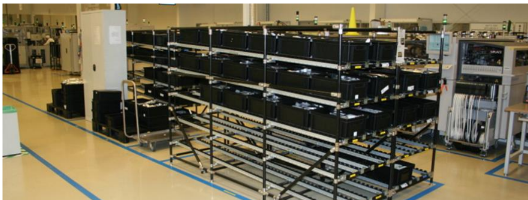
Kuva 4.20. Kevytrakenteinen ja räätälöitävä läpivirtaushylly. www.pek3.com
