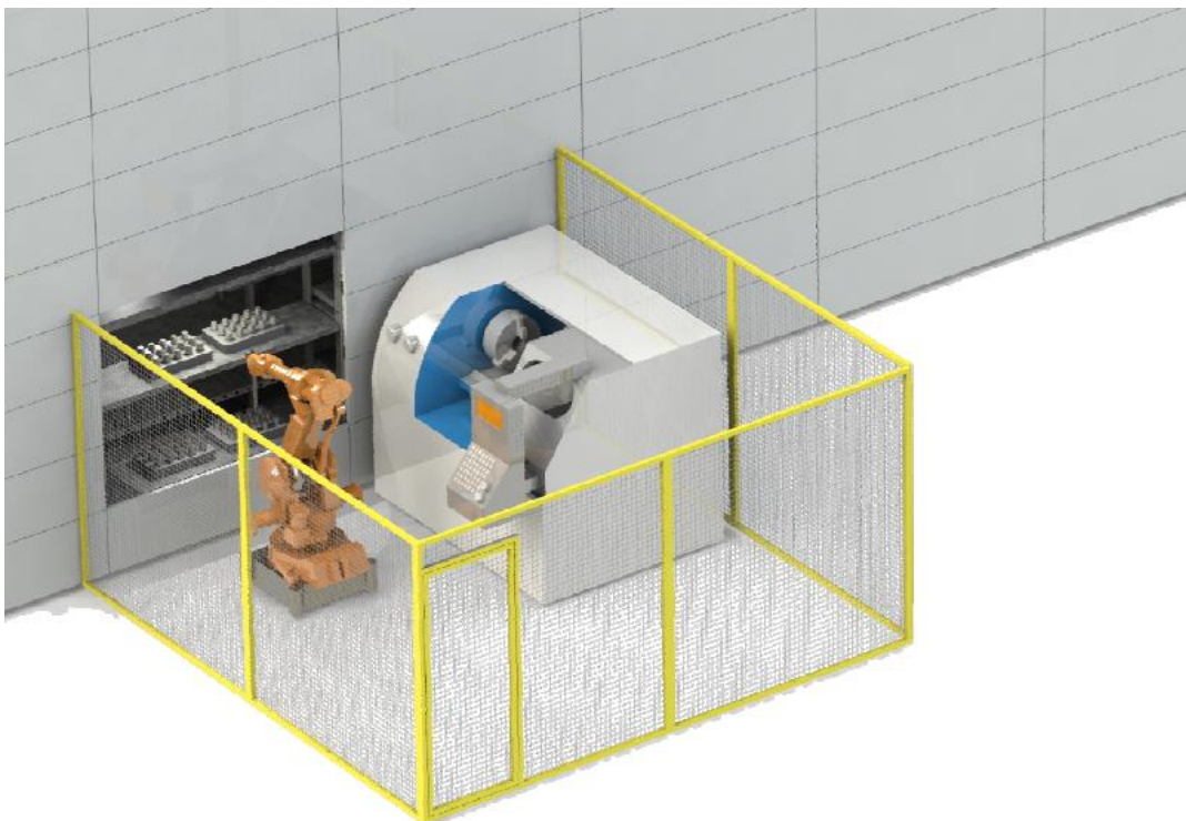
Kuva 5.3 Robottisolu nk. Agilon varastoautomaatin yhteydessä ( www.konecranes.com ) Kai Lindforsin toimittamasta myyntiesitteestä otettu kuvakaappaus.
